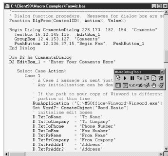
ダイアログ・エディタとOLEサポートする強力なBasicスクリプト言語でマクロを記述
