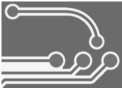
基板上の任意のオブジェクトの周囲に複雑なポリゴンを配置することができます。
