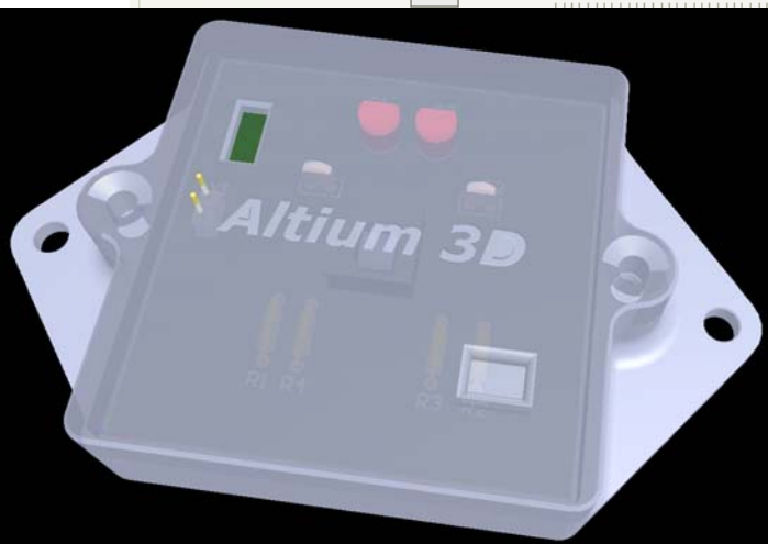
図 15. multivibrator の筐体が組立られた。透過表示を使用することで、組み立てた後の内部モデル見る事ができる
