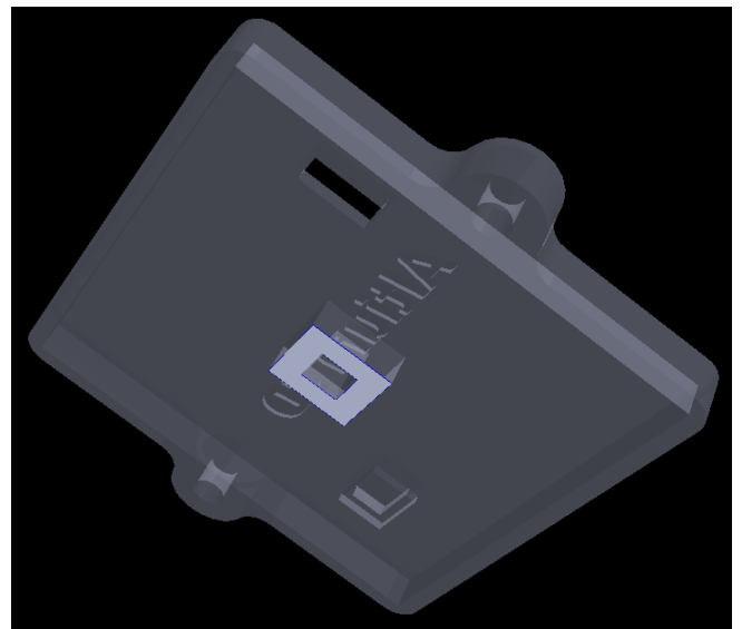
図 6. ボードと平行にするために選択した STEP モデルの表面
